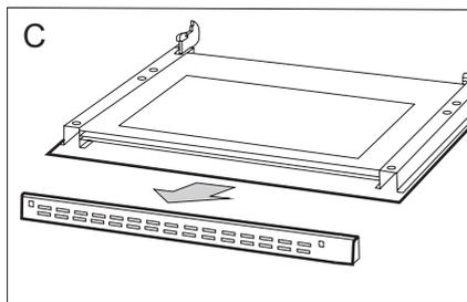
3. Décrochez la vitre intérieure de sa fixation (en partie inférieure de la porte). Attention ! Risque de dommages à la fixation des vitres. Enlever la vitre en la glissant, ne pas la soulever en haut. Extraire la vitre intérieure (schéma D).
