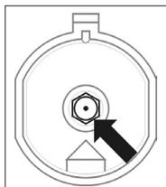
Changement de l'injecteur du brûleur de la plaque de cuisson – dévisser l'injecteur à l'aide d'une clé d'un diamètre 7 et le remplacer par un injecteur adapté à la famille de gaz (voir tableau ci-dessus).
