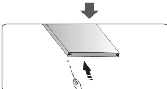
6. Posez le réfrigérateur sur un emballage en mousse souple ou un matériau similaire. Retirez les deux parties inférieures des pieds réglables et la partie inférieure de la charnière en dévissant les vis autotaraudeuses de la bride spéciale.
