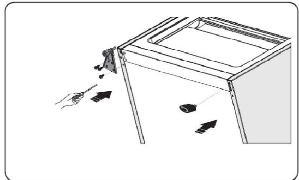
8. Transférer la porte à la position de propriété, ajuster la partie inférieure de charnière, introduire l'axe de charnière dans le trou inférieur de la porte.
