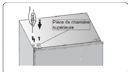
10. Installez le couvercle du trou de vis dans le coin supérieur droit du réfrigérateur. Installez le couvercle supérieur de la charnière (qui se trouve dans le sac en plastique) dans le coin gauche. Mettez l'autre couvercle supérieur de charnière dans le sac en plastique.
