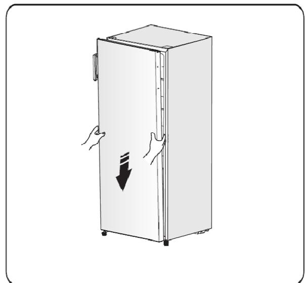
9. Transférer la partie supérieure de la charnière, introduire l'axe de la charnière supérieure dans le trou supérieur de la porte et ajuster la position de la porte (en la maintenant avec la main), en fixant la partie supérieure de la charnière avec les vis auto-taraudeuses spéciales de la bride.
