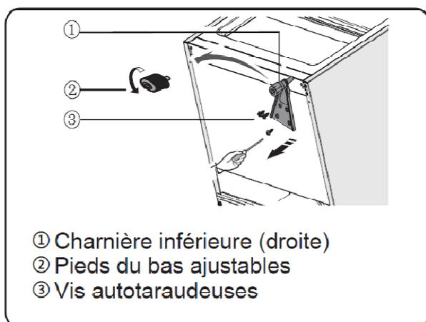
7. Replacer la partie inférieure de la charnière vers la gauche et la fixer avec les vis auto-taraudeuses spéciales de la
