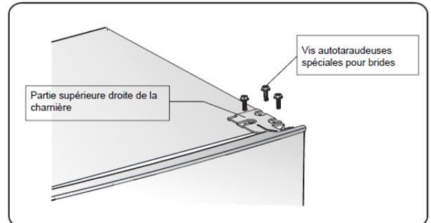
3. Retirez l'axe supérieur de la charnière, transférez-le sur le côté renversé et serrez-le fermement, puis placez-le dans un endroit sûr.
